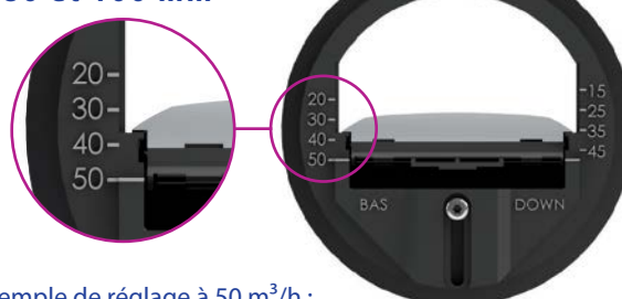
Exemple de réglage à 50 m 3 /h : régulateur calé sur le repère gauche «50»
