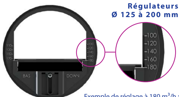
Exemple de réglage à 180 m 3 /h : régulateur calé sur le repère droit «180»
