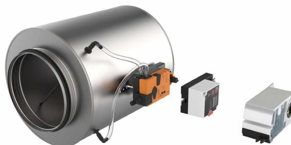
Les capteurs de pression dynamique ont une plage de fonctionnement de 0..600Pa, avec une résolution de  $\pm 1$ Pa. La pression maximale de fonctionnement du conduit est de 1000 Pa. Le boîtier peut également être isolé en option avec 30 mm en laine minérale et tôle gal- vanisée double peau pour la réduction du bruit rayonné du boîtier. Le clapet et les manchons de raccordement sont équipés de joints en caoutchouc.
