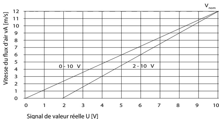
$$0 - 10 \text{ V} \quad V_{\text{act}} = \frac{U_{\text{act}} - V_{\text{nom}}}{10}$$
