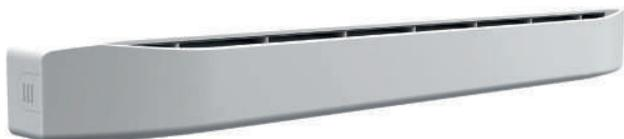
Les entrées d'air FILEA 30 se posent en applique sur la menuiserie uniquement sur réservation de 354 x 12 mm.
