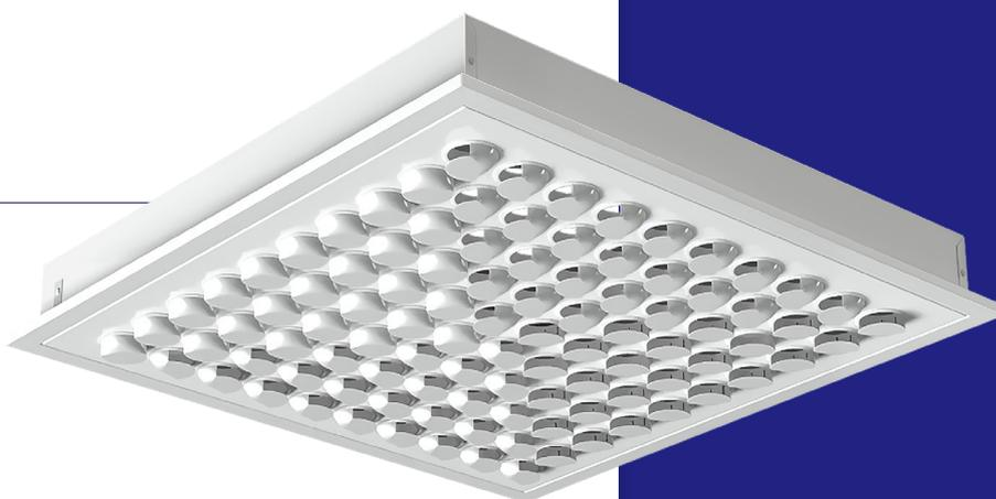
Le diffuseur est adapté à un soufflage horizontal en air froid, où une grande flexibilité d'orientation de diffusion est requise. Les buses peuvent également être orientées de façon à obtenir un jet d'air vertical, ce qui permet le soufflage d'air chaud.
