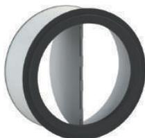
Les clapets anti-retour sont réalisés avec un corps en acier galvanisé embouti (Ø 80 à 200 mm) ou soudé moleté (Ø 200 à 400 mm).
